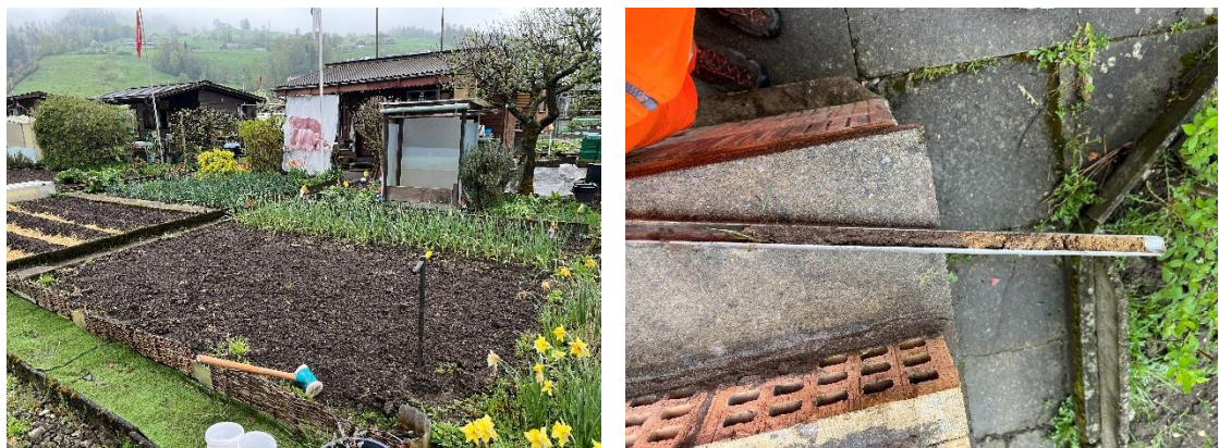
Abbildung 3: Durchgeführte Bodenentnahme mit dem Pürckhauer.
