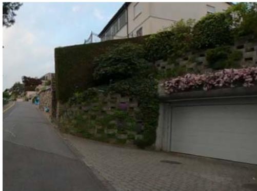
Abbildung 12: eingeschränkte Knotensichtverhältnisse aufgrund Mauer
