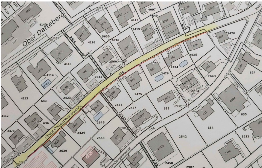
Abb. 18: Generelle Verbreiterung um 1.0m auf 220 m
